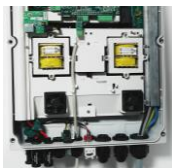
Ansicht vom RS485-1 StorEdge Wechselrichter
